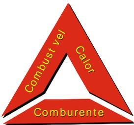
**Abafamento** - Reduzindo-se a quantidade de oxigênio da combustão, atua-se no lado do triângulo relativo ao comburente, extinguindo o fogo por abafamento. É o processo de extinção quando se utiliza  $\text{CO}_2$ , espuma ou pó químico como agente extintor.
