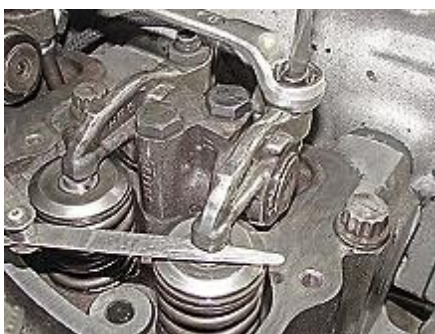
Figura 4.1.1.2 – Regulando válvulas (Scania DS)
